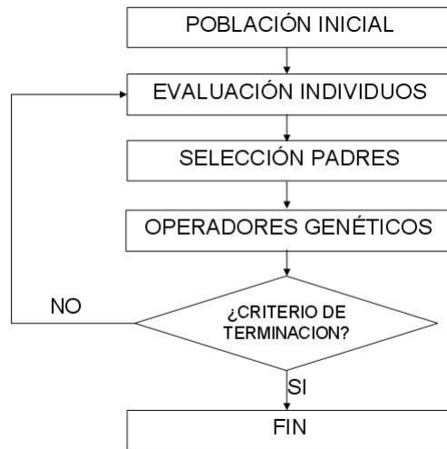
Figura 4.7: Proceso de un algoritmo genético básico
