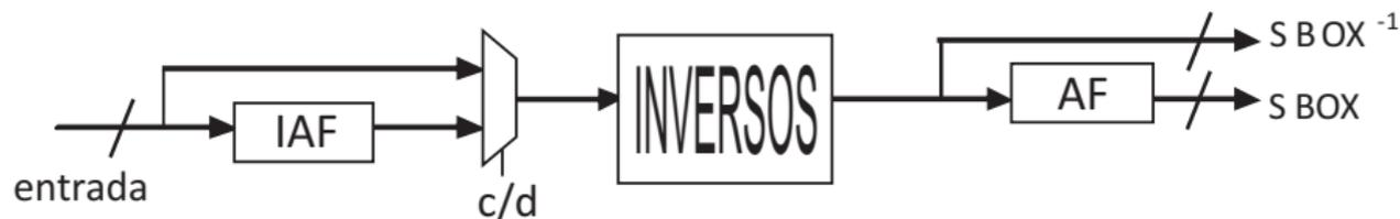
**Figura:** Arquitectura para la sustitución de bytes (BS) y su inversa (iBS).
