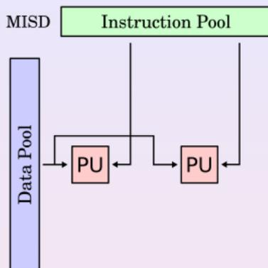
La clase **MISD** implica la ejecución de varias instrucciones operando simultáneamente sobre un solo dato.
