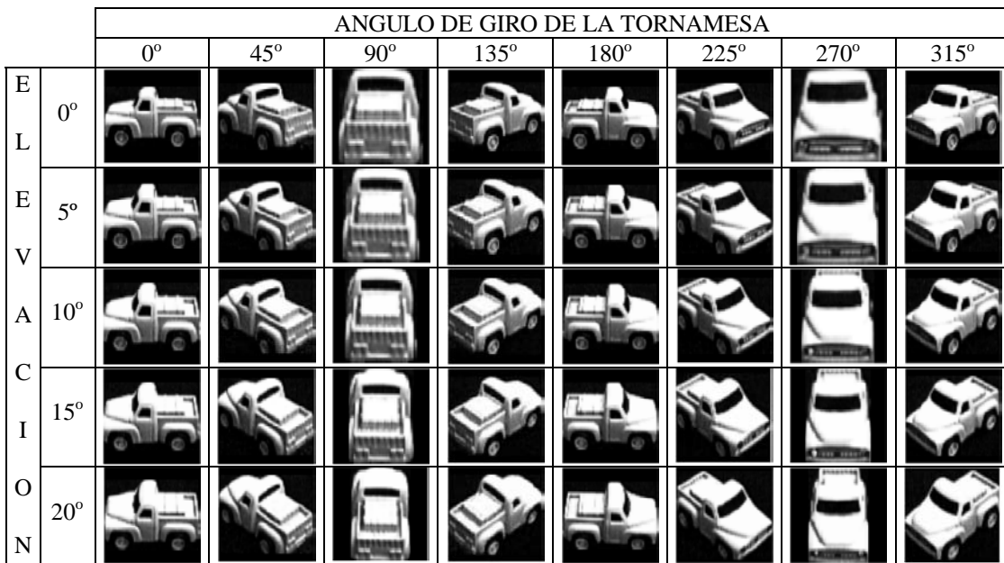
Figura 21: Un ejemplo de la forma de adquirir imágenes para un objeto, para construir su modelo bajo 2 parámetros, empleando un muestreo uniforme con 45^\circ de incremento en el ángulo de giro de la tornamesa y 5^\circ de incremento en el ángulo de elevación de la cámara, respecto al plano de la tornamesa, entre imágenes consecutivas.
