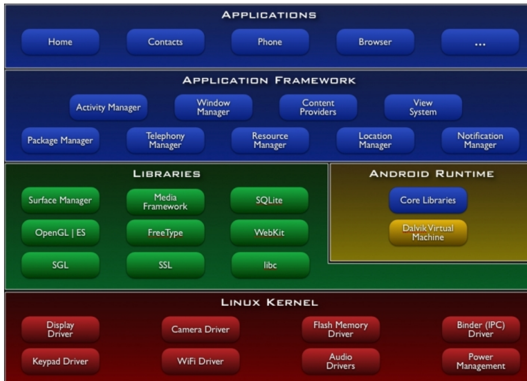
Figura 2.1: Arquitectura del Sistema Operativo Android
