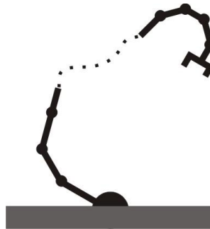
Fig. 4.7 Robot manipulador planar de N-gdl.
