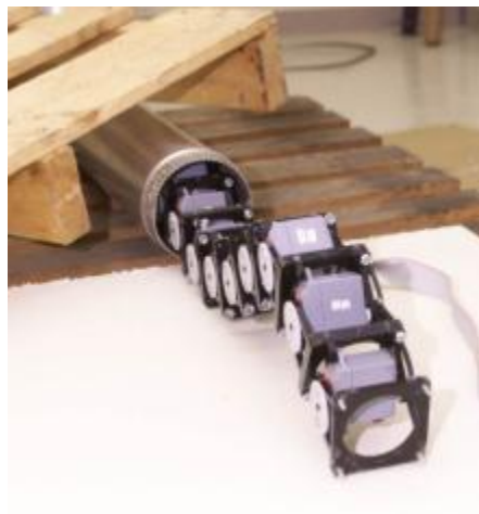
Fig. 4.5 Robot tipo serpiente constituido de módulos.
