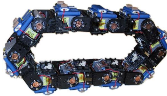
Fig. 4.6 Robot modular ensamblado como oruga.
