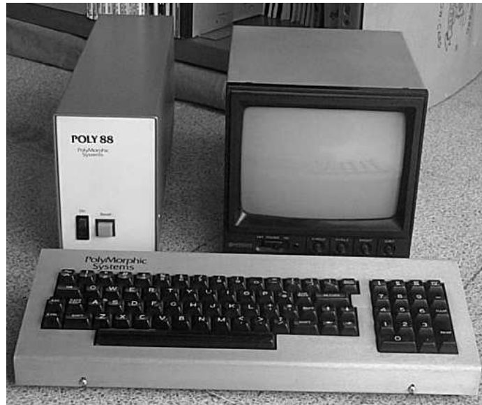
POLY 88, una de las primeras microcomputadoras. Emplea el 8080 y fue contruida por PolyMorphic Systems.
